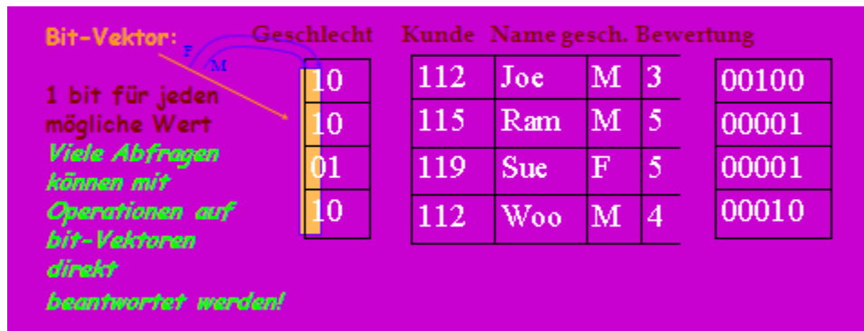
Abbildung 2: Konzept des Bitmap Indexes
